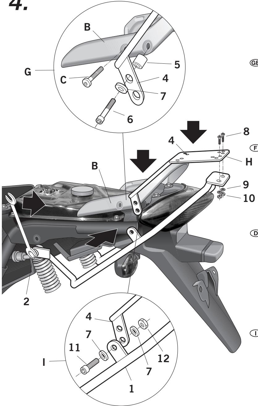
(E) Montar el agarradero original (B) conjuntamente con el soporte KIT TOP (4), EN ZONA G mediante los tornillos (C), los distanciadores (5), los tornillos (6) y arandelas (7). Unir el soporte KIT TOP (4) al soporte varilla (1), en zona H mediante los tornillos (8), arandelas (9) y tuercas (10). Y en zona I, mediante los tornillos (11), arandelas (7) y tuercas (12). **Importante:** Apretar ahora fuertemente los tornillos (2). Desmontar el soporte Kit Top (4) y el agarradero original (B).
