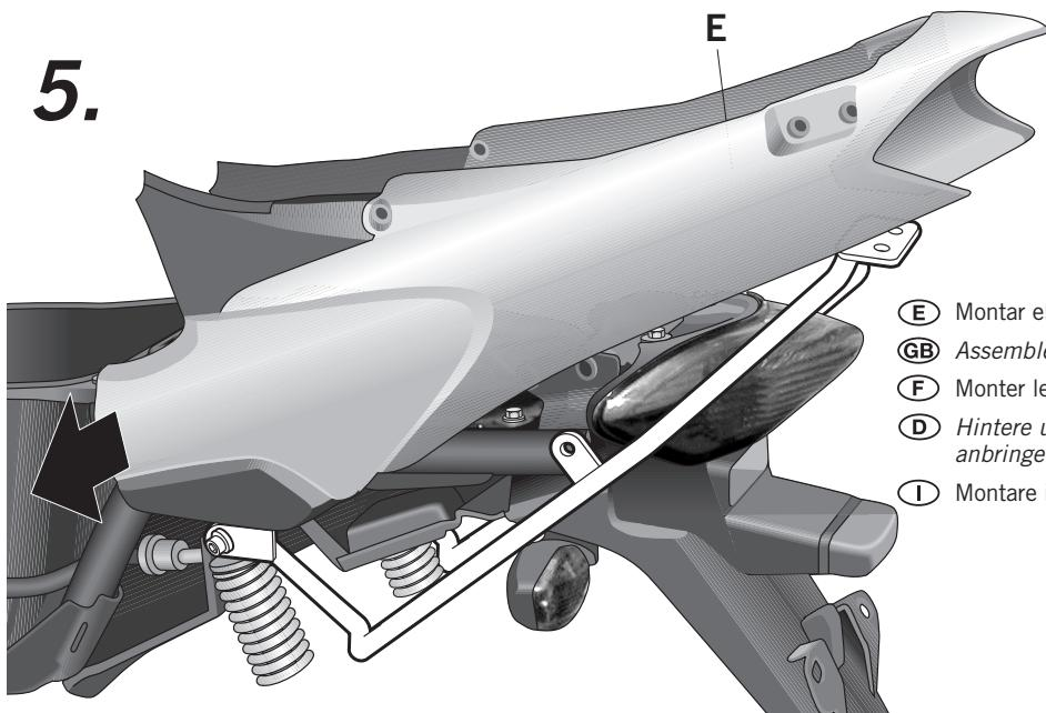
(E) Montar el carenado posterior y laterales (E).
